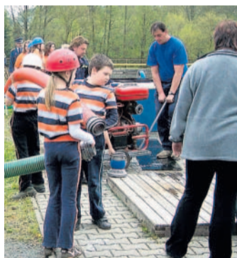
Jak na to Aby mohli hasiči stříkat, musí se zapojit sací hadice do čerpadla a ponořit do nádrže.
